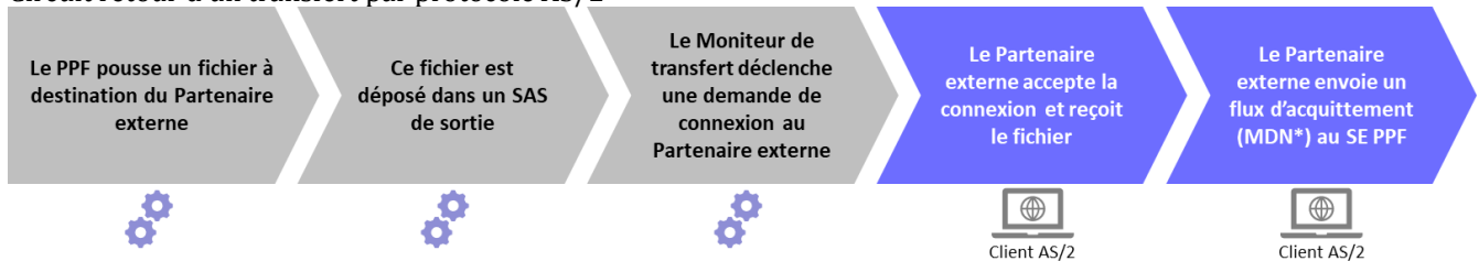
Figure 46 : Schéma d'un circuit retour d'un transfert par protocole AS/2
