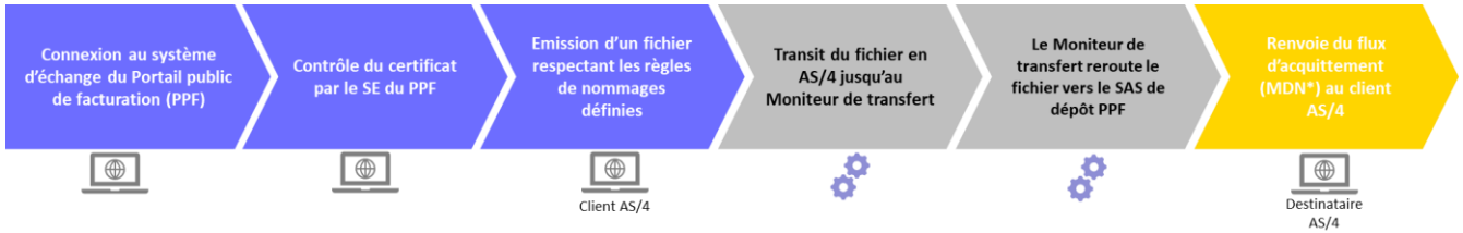
Figure 47 : Schéma d'un circuit aller d'un transfert par protocole AS/4
