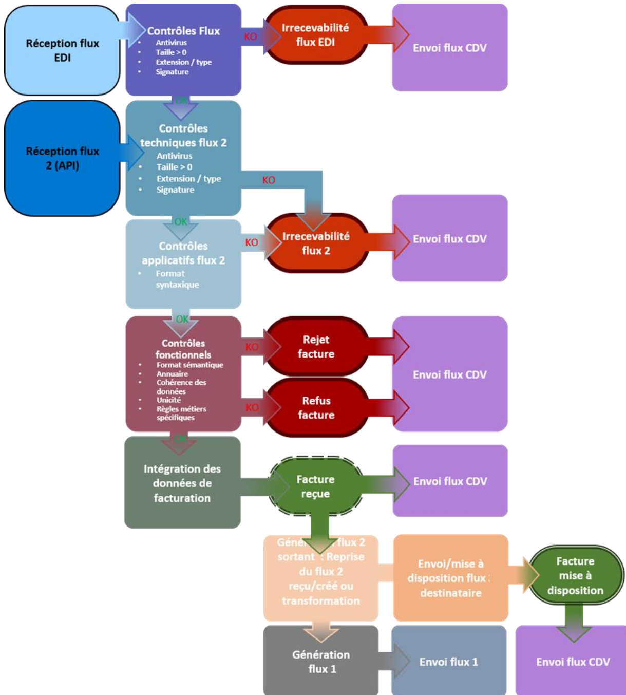
Figure 9 : Processus du cycle de vie d'un flux et d'une facture au sein du PPF en réception
